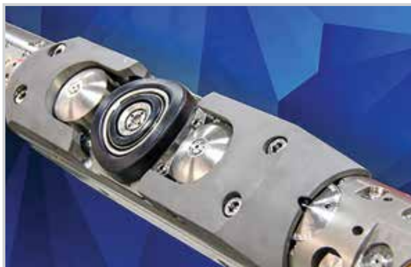
Hình 5. Thiết bị RCX eXcel lấy mẫu trong các thành tạo có độ thấm thấp và trong điều kiện áp suất - nhiệt độ cao mà không cần dùng packers trương nở
